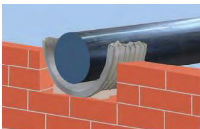
Aliniați jumătate de tub pe conducta purtătoare
