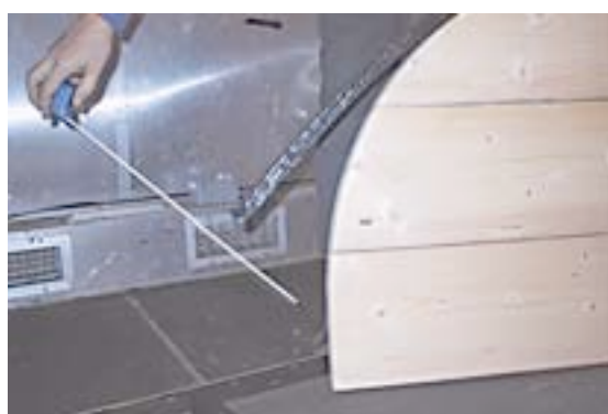
Testarea la flexibilitate in conditii de temperature scazute
